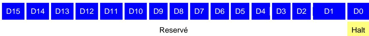
**ClearFeature** et **SetFeature** sont utilisés pour positionner les fonctions de la terminaison. Le standard défini actuellement un sélecteur de fonction de terminaison : **ENDPOINT\_HALT (0x00)** qui permet à l'hôte de bloquer et d'effacer une terminaison. Seules les terminaisons autres que la terminaison par défaut sont conseillées pour avoir cette fonctionnalité.
