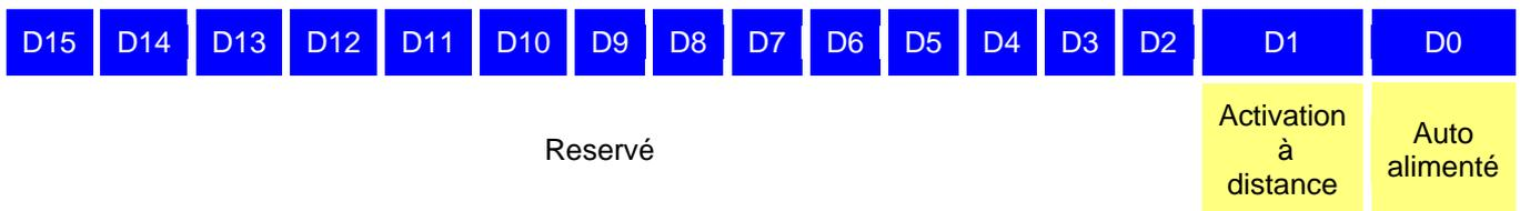
Si D0 est à 1, ceci indique que l'appareil est auto alimenté. S'il est à 0, l'appareil est alimenté par le bus. Si D1 est à 1, l'activation à distance de l'appareil est validée et ce dernier peut réveiller l'hôte pendant le mode veille. Le bit d'activation à distance peut être positionné par les requêtes **SetFeature** et **ClearFeature** grâce à un sélecteur de fonction de `DEVICE_REMOTE_WAKEUP(0x01)`.
